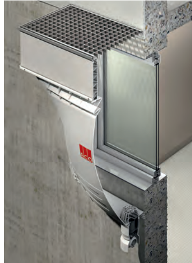
Закріплений безпосередньо на світловий приямок елемент добудови
