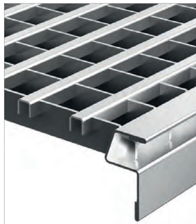
Дизайнерська решітка, профіль впродовж, нержавіюча сталь, пішохідне навантаження до 1.5 кН
