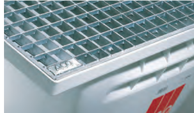
Стільникова решітка, розмір стільника 30 x 30 мм, витримує пішохідне навантаження до 1.5 кН
