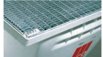
Стільникова решітка, розмір стільника 30 x 60 мм, витримує пішохідне навантаження до 1.5 кН, навантаження транспорту, навантаження на колесо до кН
