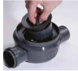
Сифон із гідрозатвором гарантує відсутність неприємних запахів в приміщенні.
