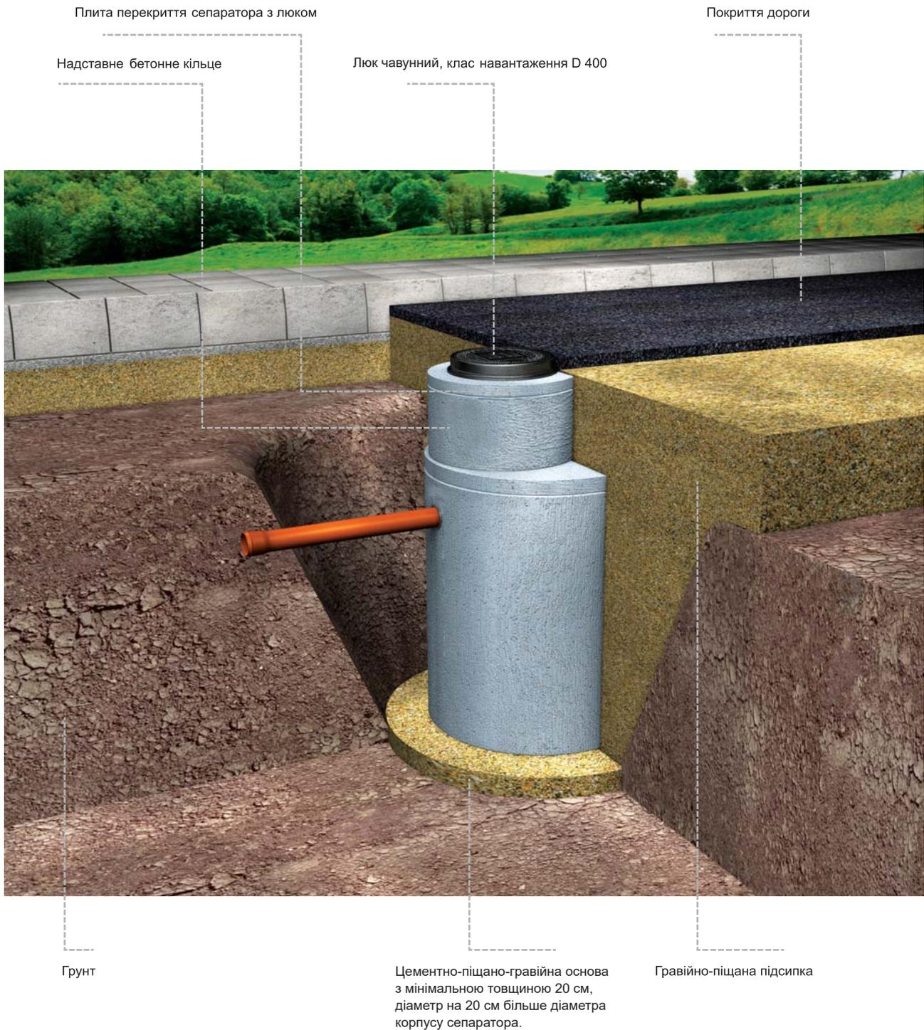
**Рекомендації з монтажу сепаратора в ґрунт на проїзній частині, клас навантаження D400, при умові високих ґрунтових вод**
