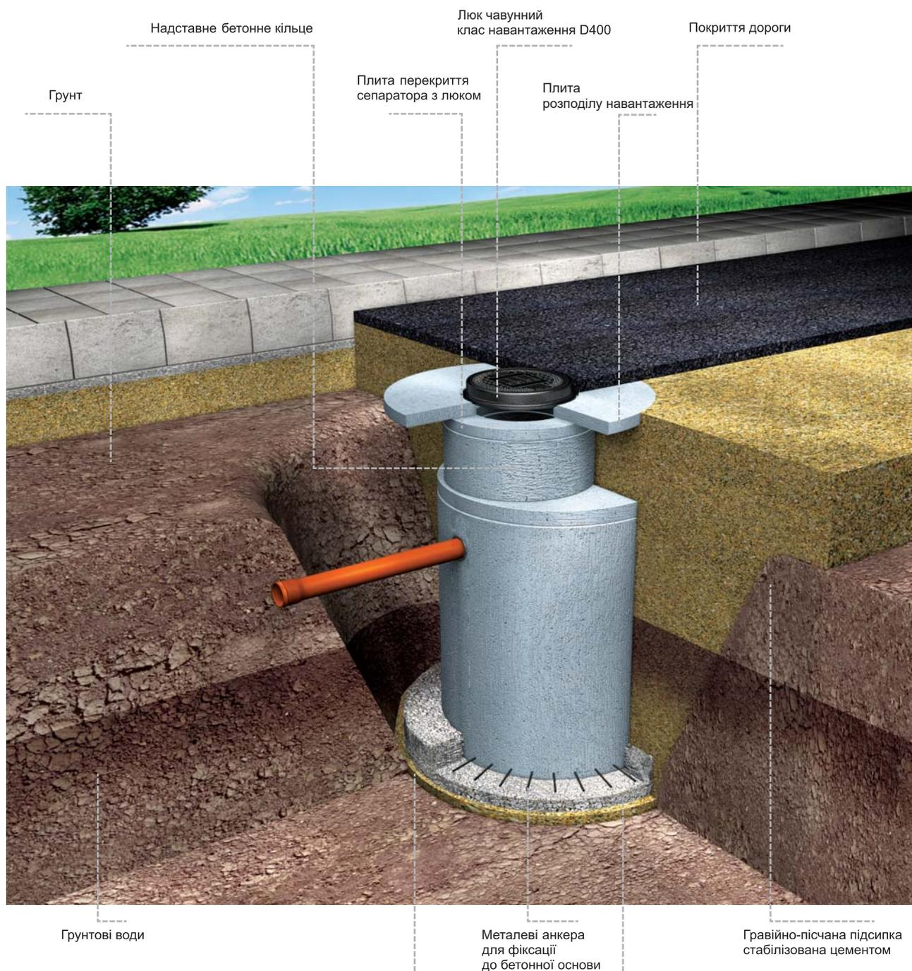
Бетонна основа (клас бетону В15) з мінімальною товщиною 20см, діаметр на 20 см більше діаметра сепаратора (параметри, товщини і діаметра відповідно до вимог проекту).
