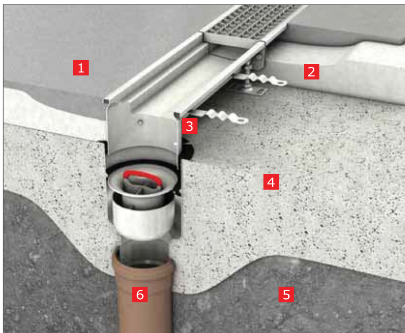
Монтаж лоткового каналу з нижньою частиною трапа.
