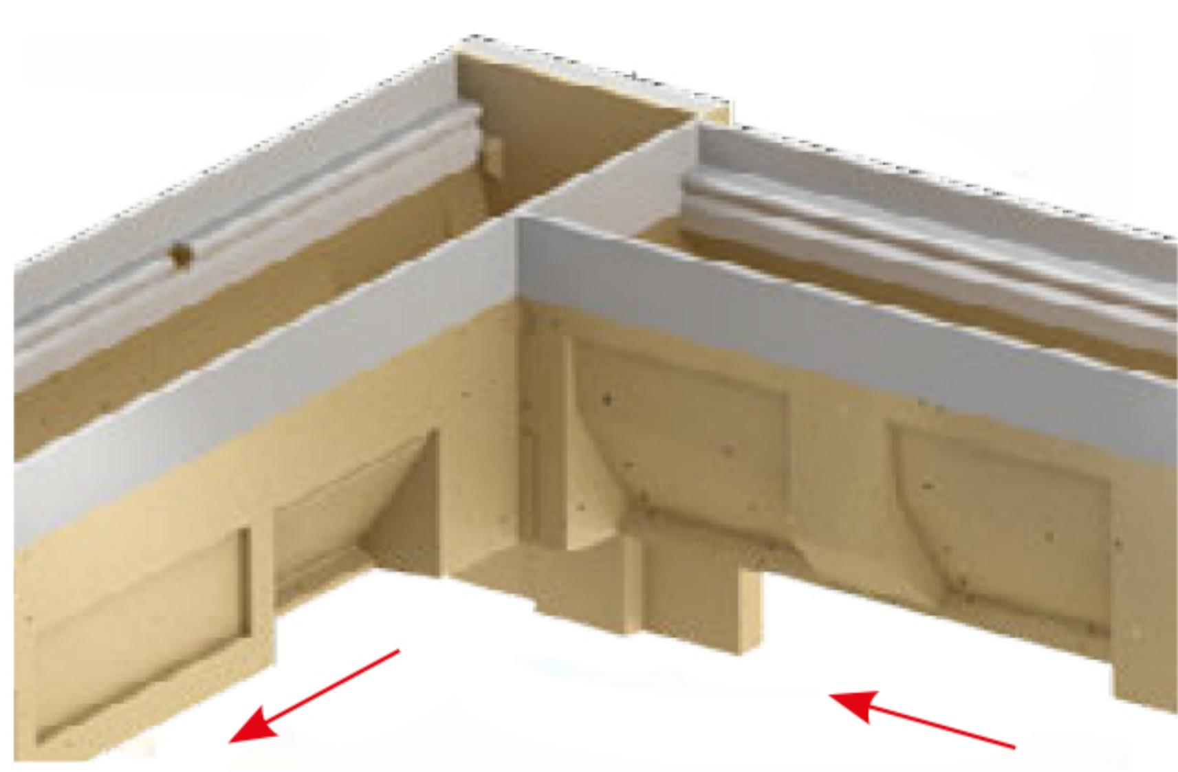
Т-подібне підключення з використанням каналу 500 мм
